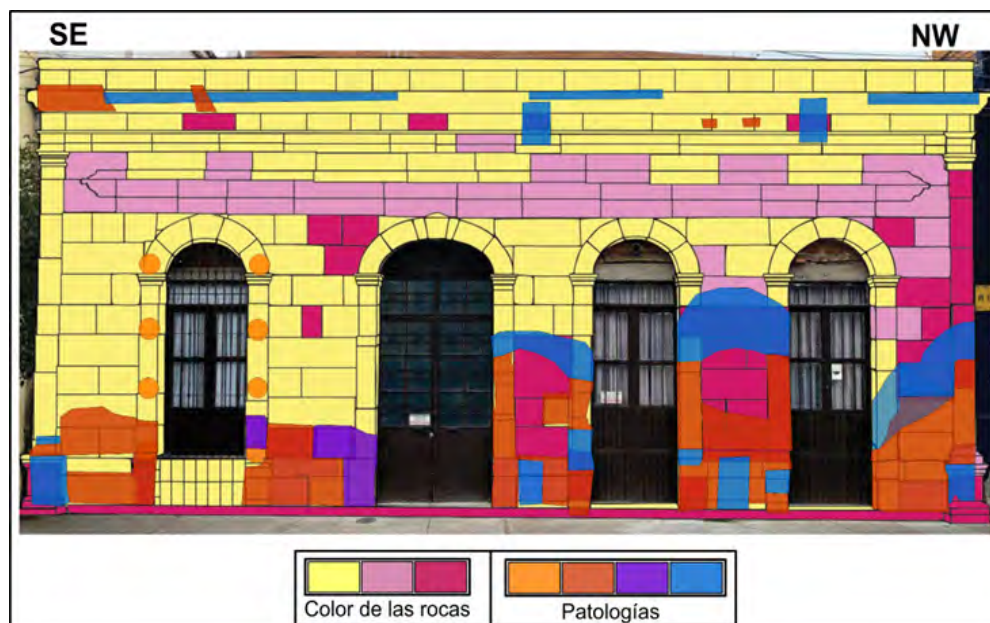
Figura 9. Sobreposición de la cartografía y las patologías presentes en la fachada del inmueble. Para mayor información sobre el tipo de rocas en esta figura, ver Figuras 6 y 7.
