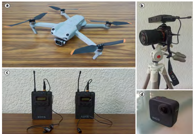
Figura 4. Equipo utilizado en campo: a. Dron DJI Air 2S; b. Cámara Sony a7 con receptor de sonido Boya montados en tripié; c. Emisoras de sonido con micrófonos Lavalier Boya; d. Cámara de acción 360 GoPRO MAX.
