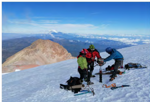
Figura 2. Extracción de un núcleo de hielo somero en el Glaciar del Citlaltépetl.
