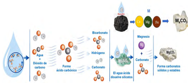
Figura 5. Proceso de retención de CO 2 en minerales. Modificado de Raza et al. 2022.
