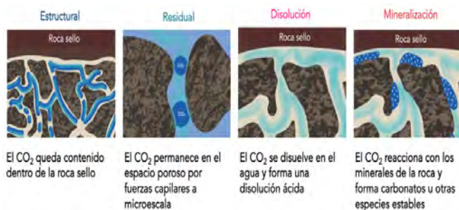
Figura 4. Mecanismos de entrapamiento durante el almacenamiento de CO 2 . Modificado de Staib et al. , 2021.
